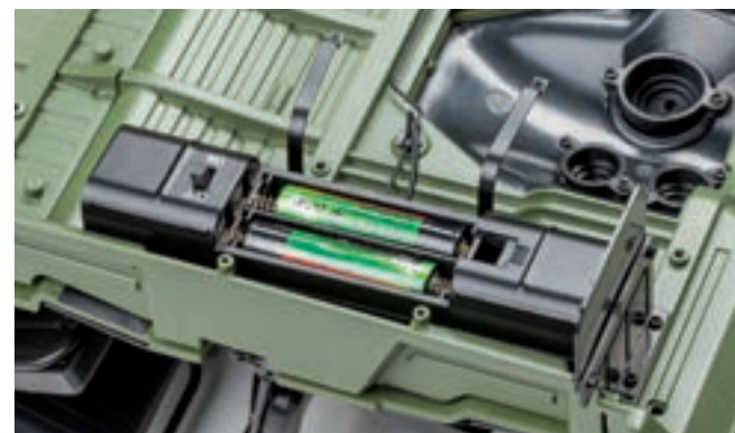
Шаг 18. Ослабьте два винта крепления хомутов на полу кузова. Отведите в стороны хомуты и откройте крышку батарейного отсека. Установите батарейки и произведите сборку бака в обратном порядке.
