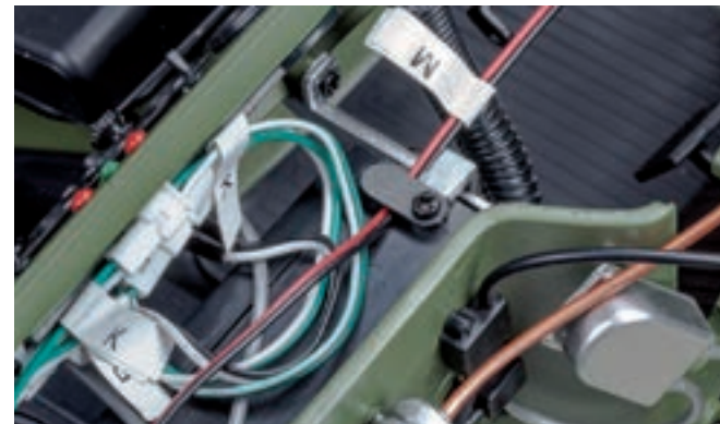
Шаг 16. Аналогичным образом при помощи фиксатора и винта 1,7×4 (AP) закрепите провод M в левой части корпуса отопителя салона. Разъем провода на данном этапе сборки остается свободным.
