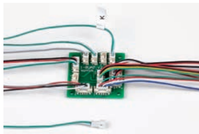
Шаг 5. В верхние разъемы платы последовательно установите провода динамика (маркировка С), выключателя звука (маркировка В) и провод подсветки панели приборов (маркировка К). Обратите внимание: третий слева разъем (маркировка А) остается свободным.
