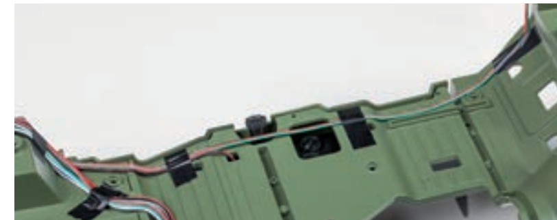
Шаг 8. При помощи отрезков клейкой ленты зафиксируйте провода на полу кузова по приведенной ниже схеме.
