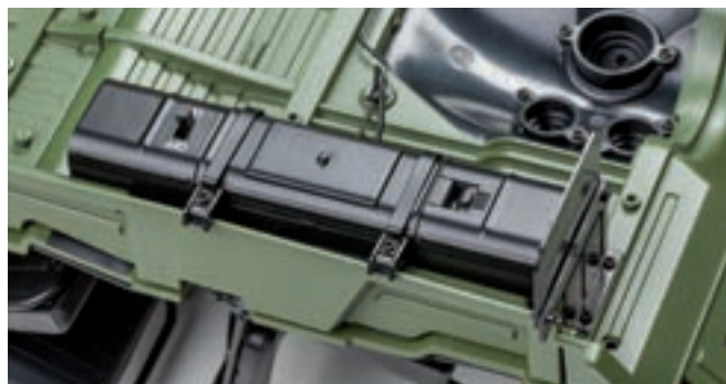
Шаг 15. При помощи фиксатора и винта 1,7×4 (AP) закрепите пять проводов на корпусе отопителя. Соединители проводов должны находиться около панели приборов.
