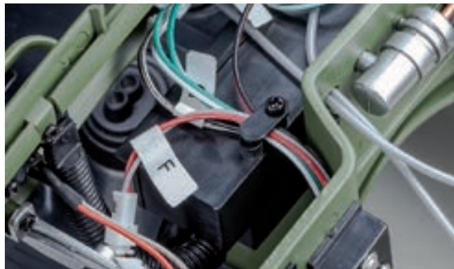
Шаг 15. При помощи фиксатора и винта 1,7×4 (AP) закрепите пять проводов на корпусе отопителя. Соединители проводов должны находиться около панели приборов.
