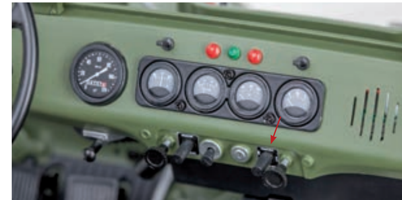
Шаг 20. При нажатии на правую кнопку в нижней части комбинации приборов должен звучать звуковой сигнал. При повторном нажатии — звук работающего двигателя. При следующем нажатии звук выключается.
