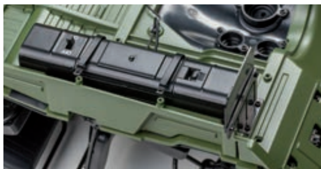
Шаг 17. Установите две батарейки типоразмера AAA в батарейный отсек. Для этого открутите два винта крепления хомутов фиксации бензобака на левом пороге модели.
