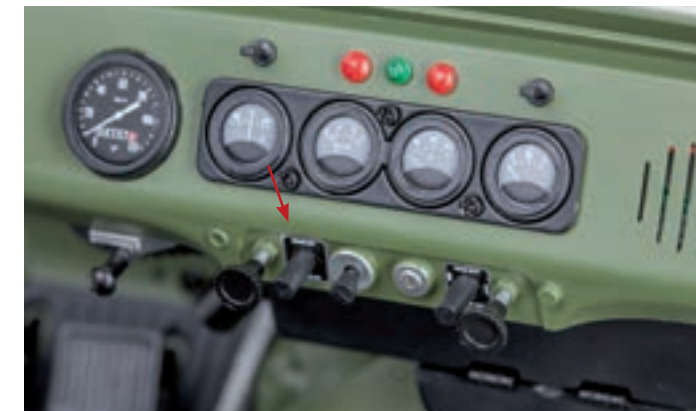
Шаг 21. При нажатии левой кнопки комбинации приборов включается подсветка приборов, щитковый фонарь, фары головного света, передние и задние габаритные огни.
