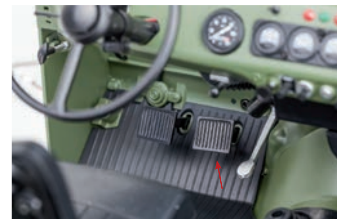
Шаг 22. При нажатии на педаль тормоза загораются фонари стоп-сигнала.
