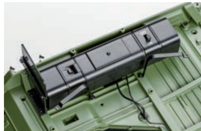
Шаг 16. Аналогичным образом при помощи фиксатора и винта 1,7×4 (AP) закрепите провод M в левой части корпуса отопителя салона. Разъем провода на данном этапе сборки остается свободным.
