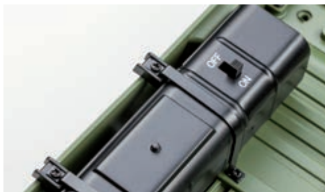
Шаг 17. Установите две батарейки типоразмера AAA в батарейный отсек. Для этого открутите два винта крепления хомутов фиксации бензобака на левом пороге модели.
